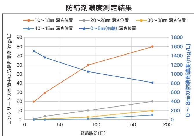
この分析結果より、現在市販されている浸透性コンクリート保護材の中で初めて、コンクリート中の鉄筋近傍に浸透している防錆剤の定量を行い、非腐食環境を形成していることを明らかにすることができました。
